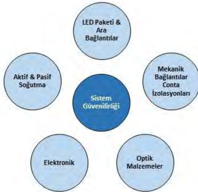
Şekil 5 – Bir LED esaslı aydınlatma armatürünün ana bileşenleri
