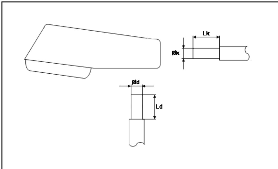
NOT : Bu resim armatürün bağlanacağı direk veya konsolun bağlantı boyutlarını göstermek içindir.
